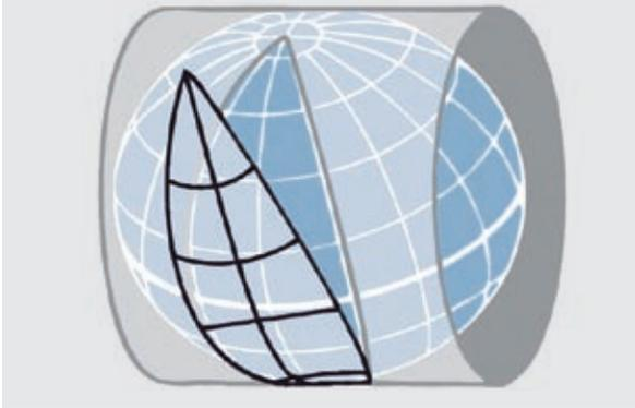
Koordinaten sind für genaue vermessungstechnische Zwecke nur innerhalb eines Meridianstreifens „kompatibel“. Weil Rheinland-Pfalz zwischen dem 6.- und 9.-Längengrad (entspricht dem 2. und 3. Meridianstreifen in der GK-Abbildung) liegt, mussten bisher meridianstreifenübergreifende Vermessungen und Darstellungen innerhalb eines Überlappungsbereichs durch eine redundante Koordinatenberechnung in beiden Streifen oder durch eine fallbezogene Umrechnung kompensiert werden.
