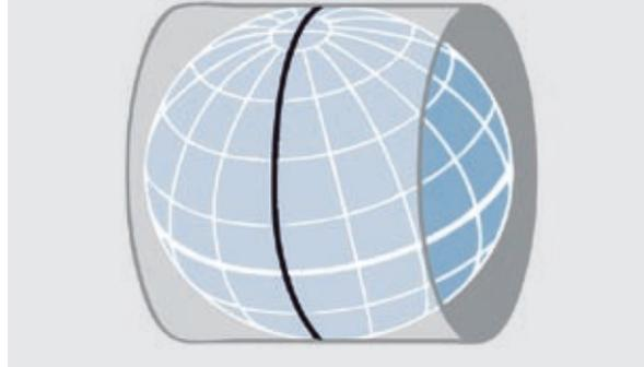
unterschiedlich festgelegt werden können. Um die auftretenden Verzerrungen für vermessungstechnische Zwecke erträglich zu machen, wird auf eine „transversale konforme Zylinderabbildung“ zurückgegriffen; dazu werden die Punkte an der Ellipsoidoberfläche (B,L) konform (= winkeltreu) auf einen Zylinder projiziert bzw. mathematisch abgebildet.
